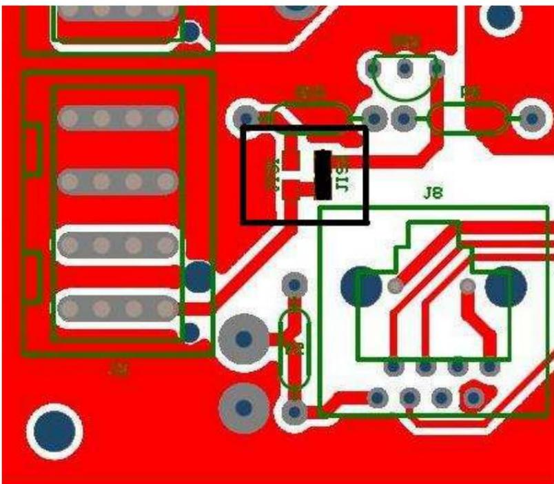
Machen Sie einen Jumper auf JIS2 und schneiden Sie den JIS1-Jumper ab (siehe schwarze Box im Bild).
