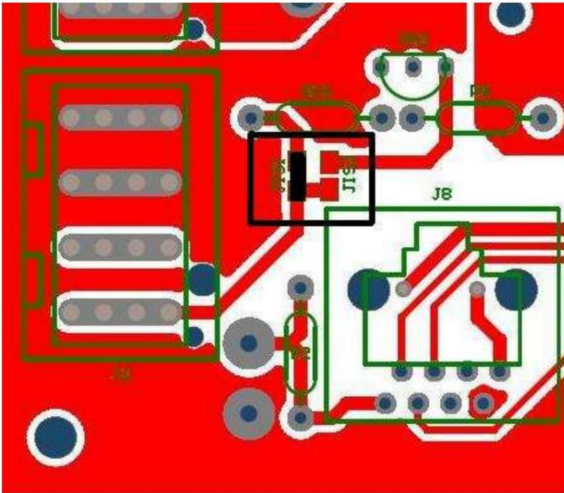
Machen Sie einen Jumper auf JIS1 und schneiden Sie den JIS2-Jumper ab (siehe schwarze Box im Bild).
