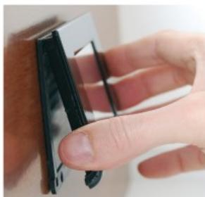
a) inserire le spine in alto della cornice display sulle sedi del coperchio retrostante tenendo sollevata la parte inferiore della cornice rispetto al coperchio;
