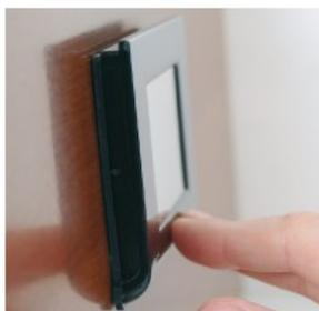
b) abbassare la parte inferiore della cornice display facendola aderire al coperchio;
